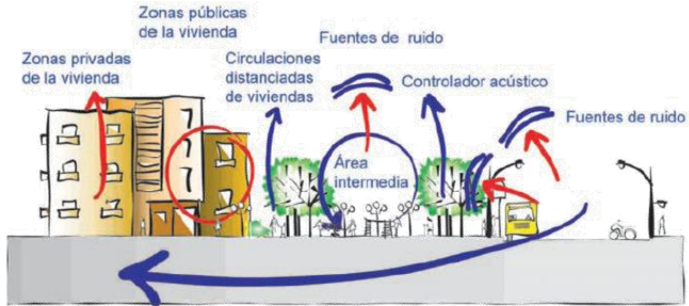
Diseño del conjunto considerando las fuentes de ruido
